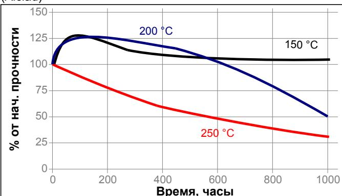
**Предел прочности на разрыв, ISO 527-3,**
