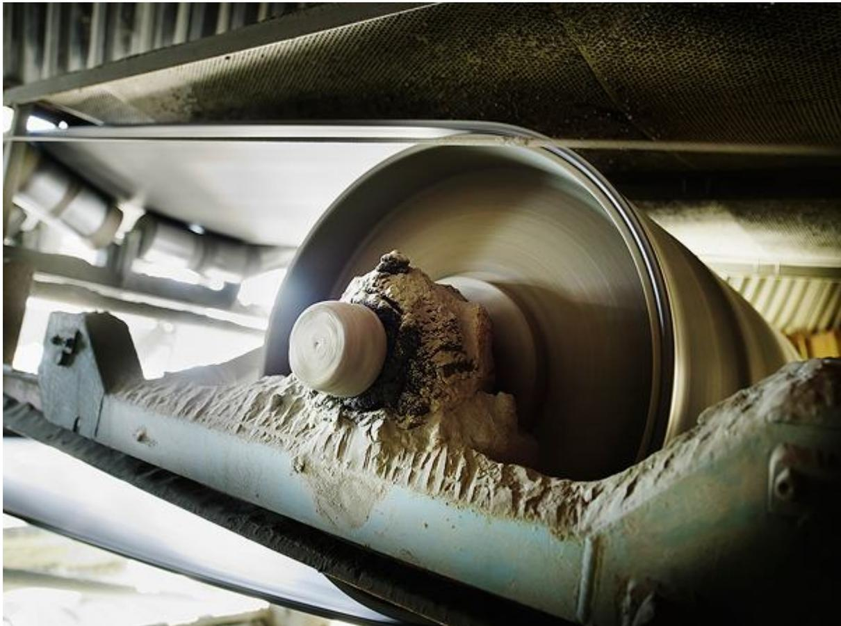
Название уплотнений – таконитовые – происходит от типа железной руды, добываемой на месторождении Месаби в штате Миннесота, США. Этот высокоабразивный материал обладает высокой проникающей способностью, и его попадание в подшипники приводит к их быстрому выходу из строя. Для решения этой проблемы, начиная с 1960-х гг., инженеры разрабатывали так называемые «таконитовые уплотнения», которые способны предотвратить проникновение в подшипники абразивной пыли во влажных средах.
